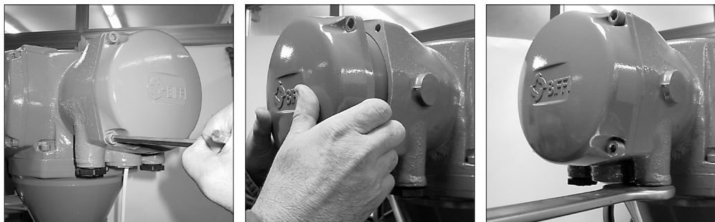
Figura 8. Entradas de cabos
