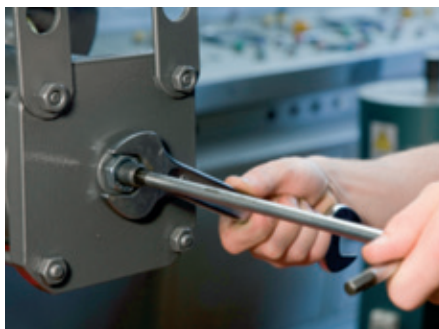
Regolazione della vite del fermo meccanico posizionata sulla flangia terminale del pacco molle
