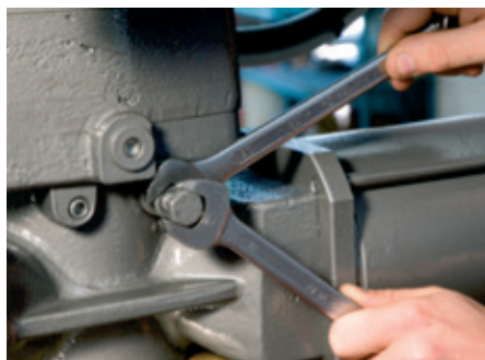
Regolazione della vite del fermo meccanico posizionata sul corpo dell'attuatore
