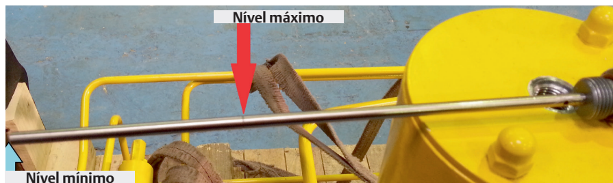
Figura 37. Vareta medidora de nível
