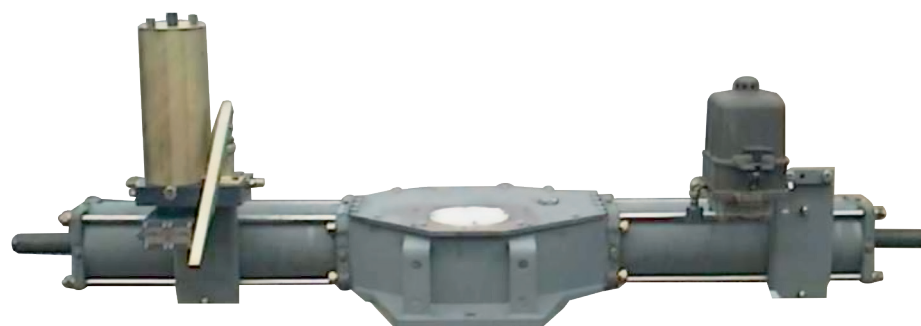
Figure 24. Actionneur doté de deux vérins
