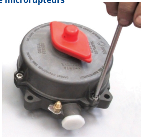
Figure 34. Boîtier de microrupteurs
